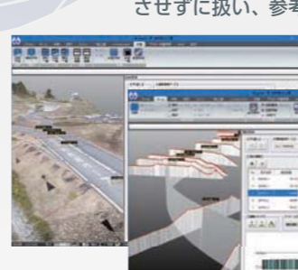
3D 点群からの縦横断データの切り出し
