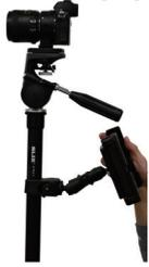
デジタルカメラをソフトウェアからコントロールすることで、ひび割れ計測に適した撮影を行うことができます。撮影結果はソフトウェア上でリアルタイムにスティッチ（簡易スティッチ）され、ラップ状況を確認しながら撮影を進められるため、漏れを抑制することができます。
