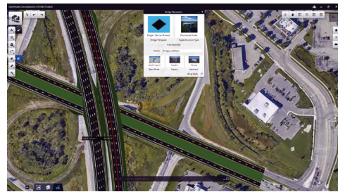
Bentley の OpenRoads ConceptStation によるリアリティメッシュを活用した道路設計
