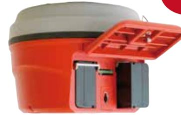
Li-ion バッテリーを2個搭載。ホットスワップ対応で観測中でも交換が可能です。
