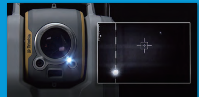
周囲が暗い現場での観測作業をアシスト
