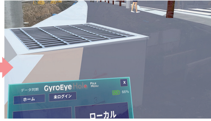
集水桝。高さ、角度も高精度に重畳された
